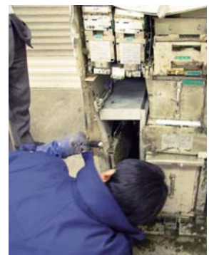
津波で著しい損傷を受けたATMは20台。エンジニアも立ち会い、筐体が歪んだATMからユニットなどを取り出した
