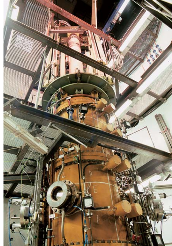
アーヘン工科大学(ドイツ)の酸素燃焼試験装置 写真提供：アーヘン工科大学 Courtesy of © Peter Winandy
