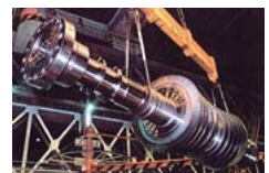
火力発電に使用する高効率の600°C級高圧タービン
