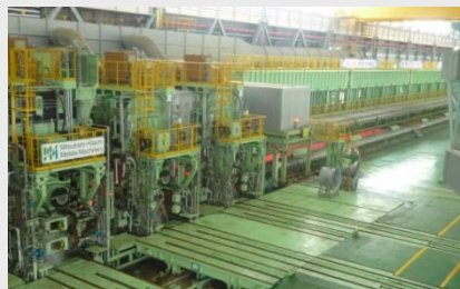
韓国・東部製鉄社向け熱間圧延 制御システムを開発・納入
